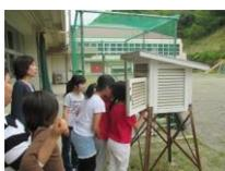
百葉箱は、気温を正確に測るために作られたもので、地面から1.2mから1.5mの高さに設置され、直射日光の影響を受けないよう真っ白なガラリっています。また、中を見るために開く扉も北側に付けられています。
